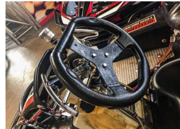
Bei den Handicap Karts erfolgt die Betätigung von Gas und Bremse über Handbedienelemente am Lenkrad. Foto: Sport Club ohne Grenzen
